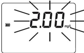
**Über dem Messbereich:** ein blinkender Wert der maximalen Konzentration zeigt an, dass der Messbereich überschritten wurde. Die Probenkonzentration liegt über dem programmierten Bereich: verdünnen Sie die Probe und führen Sie die Messung erneut durch.
