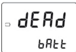
**Dead battery:** Batterie leer. Dies zeigt an, dass die Batterie leer und ein Batterie erforderlich ist. Sobald diese Meldung erscheint, blockiert das Gerät. Wechseln Sie die Batterie und schalten Sie das Gerät wieder ein.
