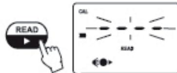
Hinweis: Erscheint im Display “STD HIGH” ist der Standardwert zu hoch. Erscheint im Display “STD LOW” ist der Standardwert zu niedrig. Überprüfen Sie, ob die Küvetten A und B des CAL CHECK™ Standards HI 96705-11 frei von Fingerabdrücken und Schmutz sind, und korrekt in den Messschacht eingesetzt wurden.
