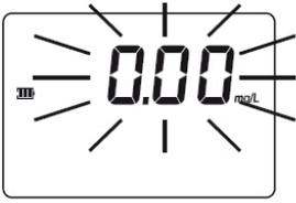
**Unter dem Messbereich:** die blinkende Anzeige "0.00" weist darauf hin, dass die Probe weniger Licht als die Blindprobe absorbiert. Überprüfen Sie den Vorgang und stellen Sie sicher, dass für Nullabgleich und Messung ein- und dieselbe Küvette verwendet wird.
