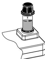
5. **Null** drücken. Das Display zeigt einen Countdown von 30 Sekunden an. Um den Countdown zu umgehen, **Null** erneut drücken. Nach Ablauf des Countdowns führt das Gerät die Messung aus. Das Display zeigt „-0,0-“ und das Gerät ist zur Messung bereit. Küvette aus dem Messschacht nehmen.
