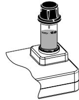
8. **Messen** drücken. Das Display zeigt einen Countdown von 1 Minute an. Um den Countdown zu umgehen, **Messen** erneut drücken. Nach Ablauf des Countdowns führt das Gerät die Messung aus und zeigt den gemessenen Wert für Chlordioxid in mg/L Chlordioxid ( $\text{ClO}_2$ ) an.
