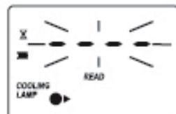
**Cooling lamp:** Das Gerät wartet, dass die Lampe abkühlt.
