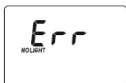
**No Light Low (Kein Licht):** das Gerät kann die Lichtmenge nicht anpassen. Bitte überprüfen Sie, dass die Proben keine Fremdkörper enthalten.
