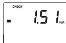
Erscheint ein anderer Wert ausserhalb des Toleranzbereiches, prüfen Sie die Küvette auf Verschmutzungen (Fingerabdrücke). Ansonsten wird empfohlen, das Photometer zu kalibrieren.
