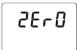
**Zero:** Ein Nullabgleich wurde nicht durchgeführt und muss zuerst durchgeführt werden. Befolgen Sie hierzu die entsprechenden Hinweise.
