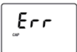
**Cap error:** erscheint bei Eindringen von Licht in die Messzelle. Vergewissern Sie sich, dass der Küvettendeckel vorhanden ist.
