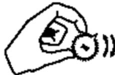
**Merke:** Kann durch Drehen des Kalibriertrimmers der gewünschte pH-Wert nicht mehr eingestellt werden, Ist eine Reinigung und evtl auch eine Erneuerung des Sensors erforderlich.
